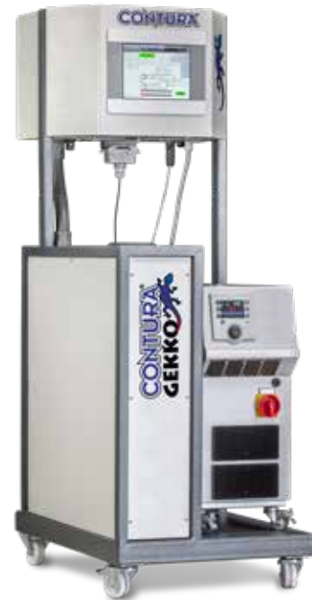
Konturfolgende Temperierung der Auswerferseite. Steuerbar in drei unterschiedlichen Kreisläufen.
