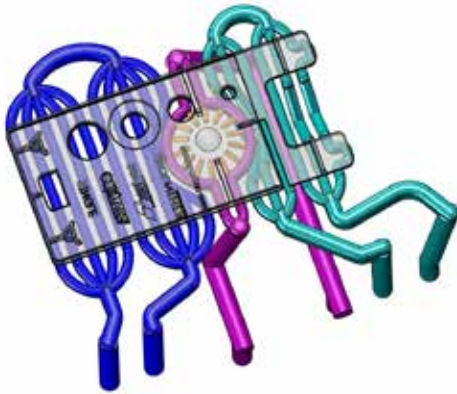
Lage der variothermen, konturnahen Temperierkanäle auf der Düsen­seite (Sicht­seite), aufgeteilt in drei Zonen.
