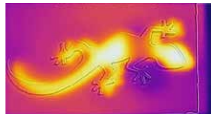
Im Wärmebild sichtbare Blockade eines Kühlkanals.
