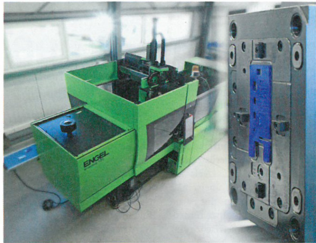
Spritzgießmaschine und Musterwerkzeug: Eine eigene Engel-Spritzgießanlage bildet das Herzstück des neuen Technikums am Standort Menden. Foto: Contura
